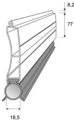
**Listwa dolna aluminiowa z uszczelką gumową**
