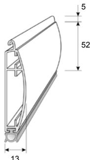
Listwa dolna aluminiowa z uszczelką gumową
